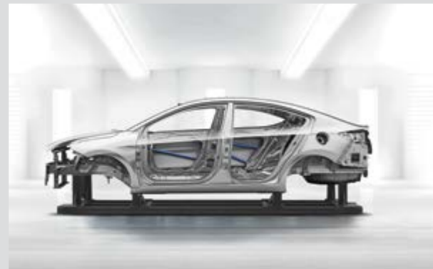
Hệ thống khung gầm (AHSS) chắc chắn
